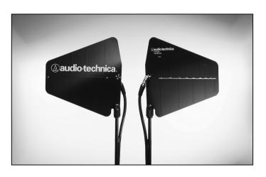
ATW-A49宽带LPDA(对数周期偶极阵-Log Periodic Dipole Array) 天线,为UHF频段440-900MHz的无线系统提供2合1式的高增益的接收能力,而接收频带已覆盖整个UHF电视通道。对装式的定向天线设计,为分集式UHF无线系统提供理想的远距离和稳定的接收表现。另外,亦可作多通道无线系统的共用天线。
