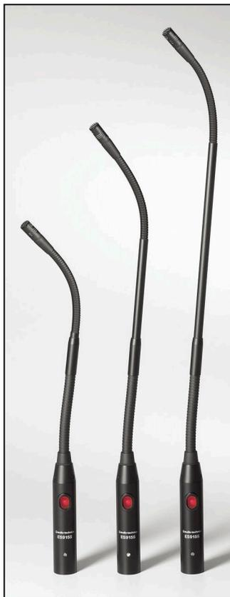
ES915SH 是一枚阔频宽的电容式超心形指向性话筒，并设有静音开关连同LED指示灯，高质量的收音效能，设计于增强收音、专业录音、电视广播、会议等高要求的收音应用。双鹅颈的设计，可将收音头灵活调校到任何位置，并附有防风海棉罩，可减低在讲话时收到不雅的喷气声及其他风声的情况出现。
