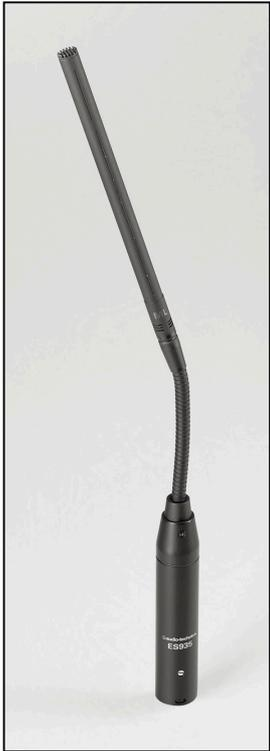
ES935ML6 是一枚阔频宽的电容式超指向性话筒，高质量的收音效能，设计于增强收音、专业录音、电视广播、会议等高要求的收音应用。鹅颈式的设计，可将收音头灵活调校到任何位置，并附有防风海绵罩，可减低在讲话时收到不雅的喷气声及其他风声的情况出现。
