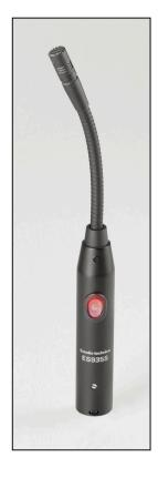
ES935SC6 是一枚阔频宽的电容式心形指向性话筒,并设有静音开关连同LED指示灯,高质量的收音效能,设计于增强收音、专业录音、电视广播、会议等高要求的收音应用。鹅颈式的设计,可将收音头灵活调校到任何位置,并附有防风海棉罩,可减低在讲话时收到不雅的喷气声及其他风声的情况出现。
